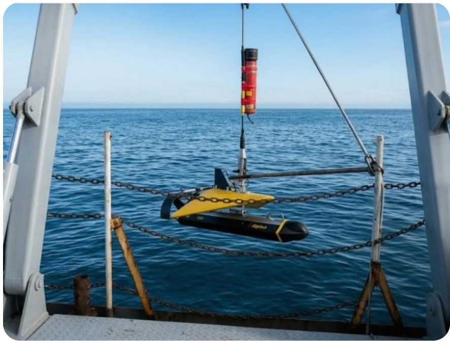
侧扫声呐搭载压载翼拖鱼海上作业
