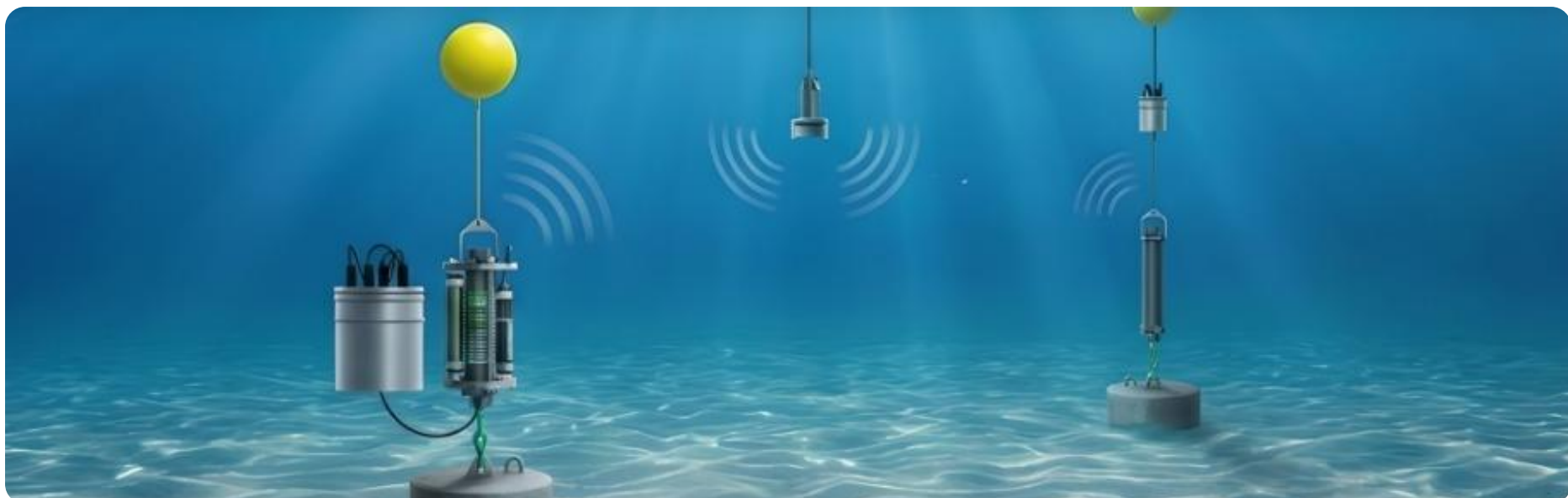
ART 系列水下声学释放器海底布放与声学遥控释放示意
