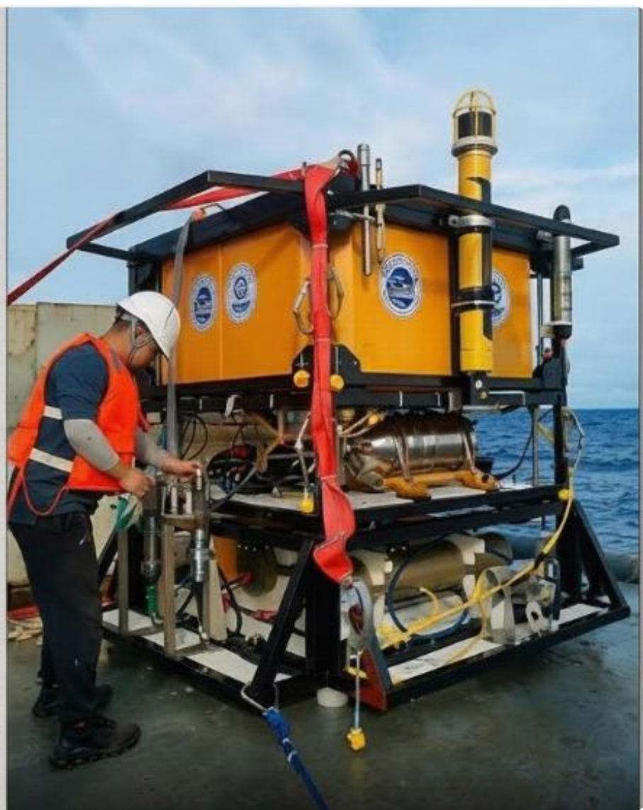
LD 系列固体浮力材料应用于水下机器人 (ROV) 浮体配套
