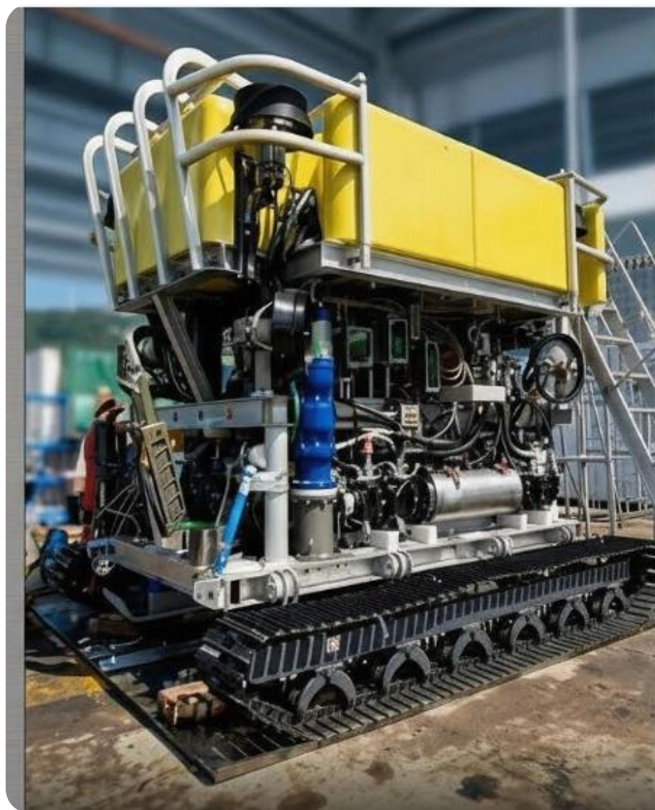
LD 系列固体浮力材料应用于水下机器人 (ROV) 浮体配套
